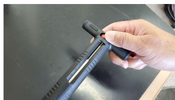
②皮むき長をダイヤルを回転させて調整
